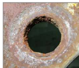
ホイールのボルト穴の損傷
